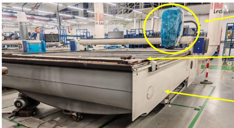
Imagem 2 – Componentes da Máquina de Corte Lectra MX9
